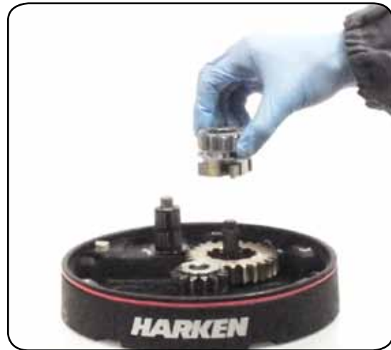
15. Remove the pawl carrier n°11
