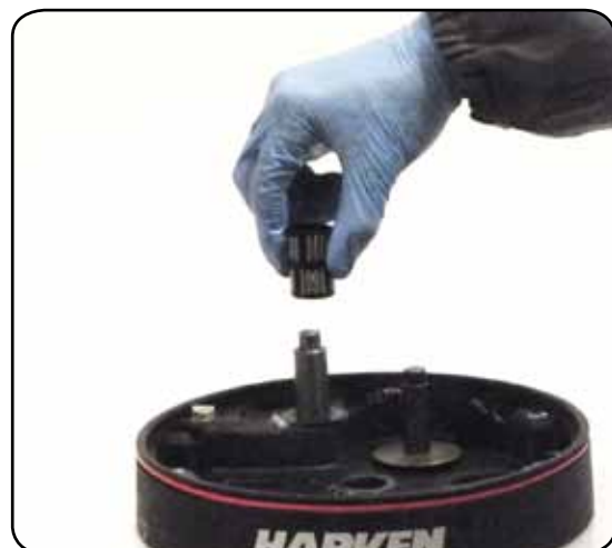
18. Remove roller bearings n°15
