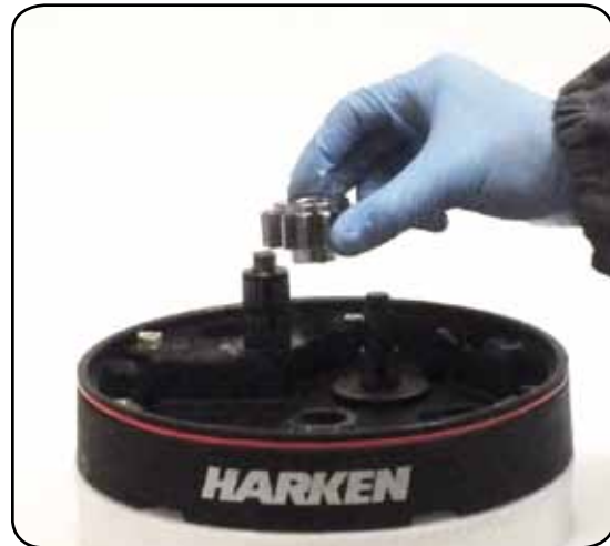
17. Remove the gear n°2
