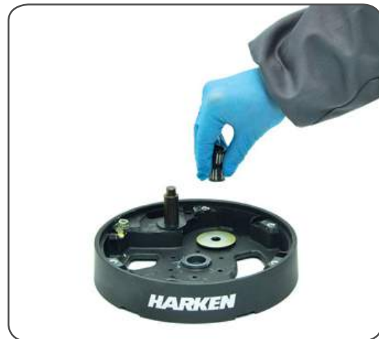
18. Remove roller bearings n°12.
