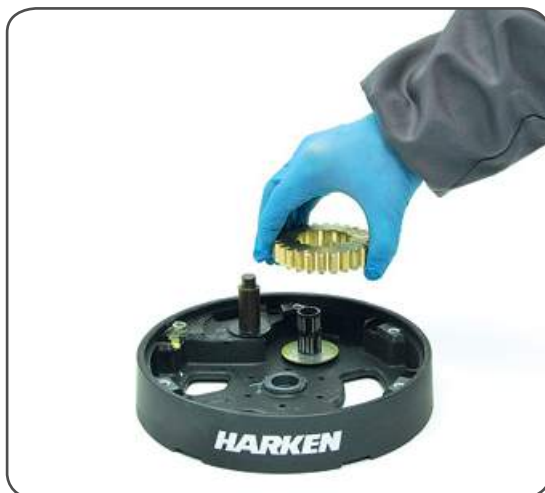
17. Remove the gear n°10
