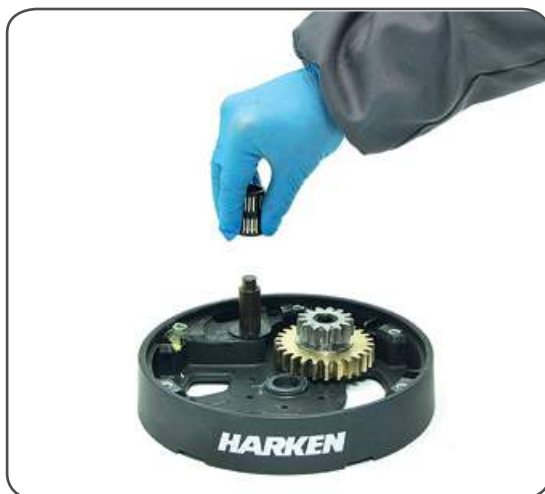
15. Remove roller bearings n°15
