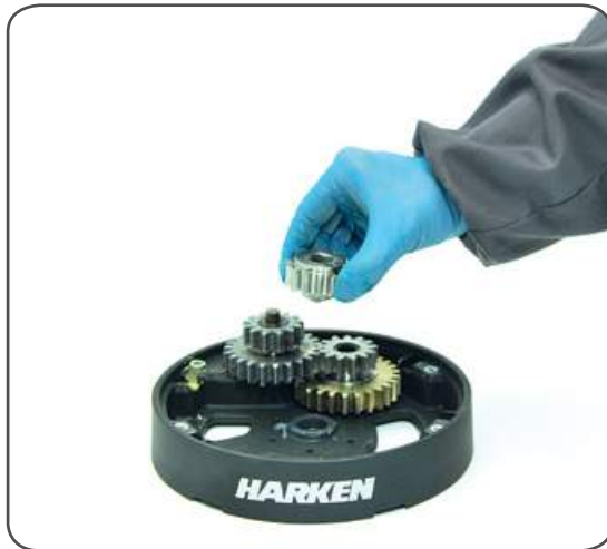
13. Remove the gear n°2.
