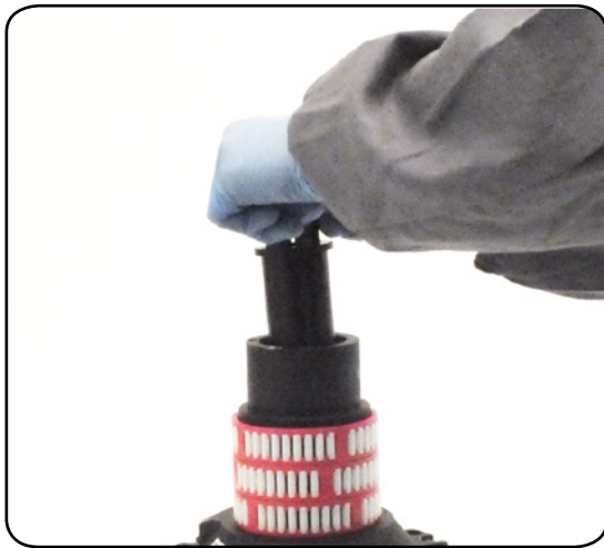
7. Slide out the assy clutch n°38
