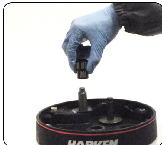
18. Remove roller bearings n°15
