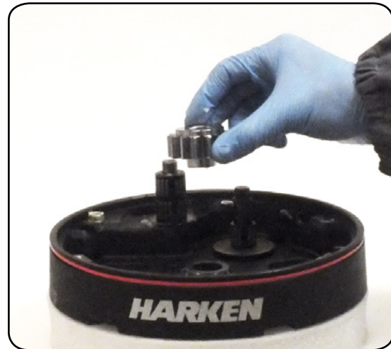
16. Remove the gear n°2
