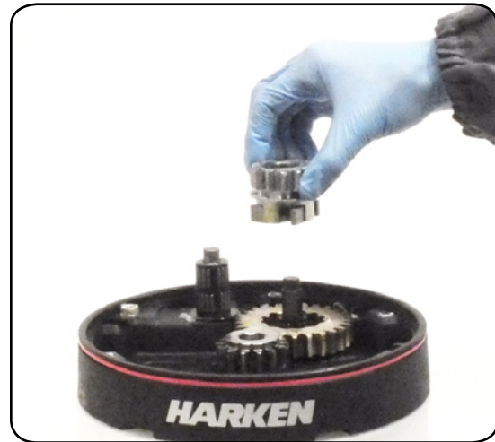
14. Remove the pawl carrier n°11
