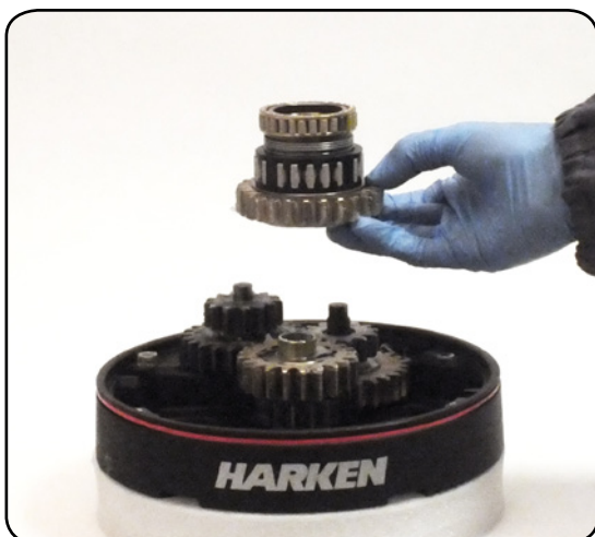
11. Remove the gear n°34, pawls carrier n°33, the bearings n°35 and 37 and the pin n°36
