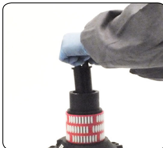
7. Slide out the assy clutch n°38
